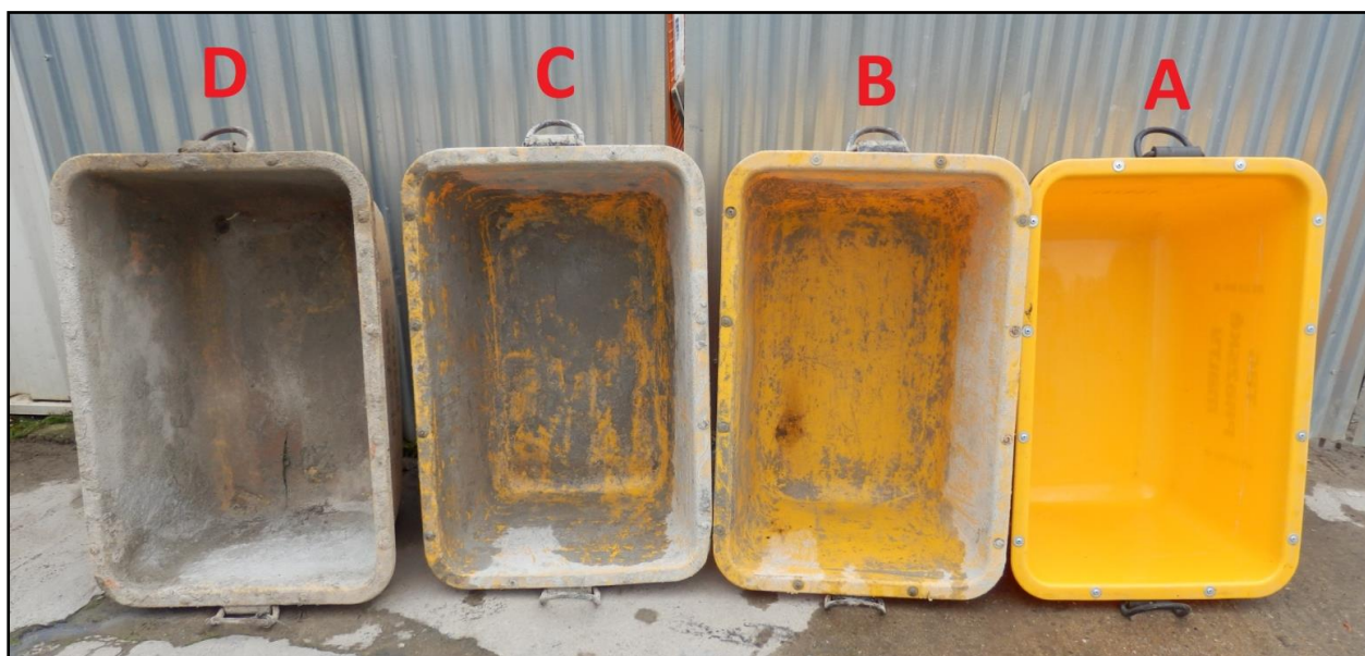
FOTO 1 – Ilustrativní vyobrazení jednotlivých kategorií opotřebení kontejnerů (van).
